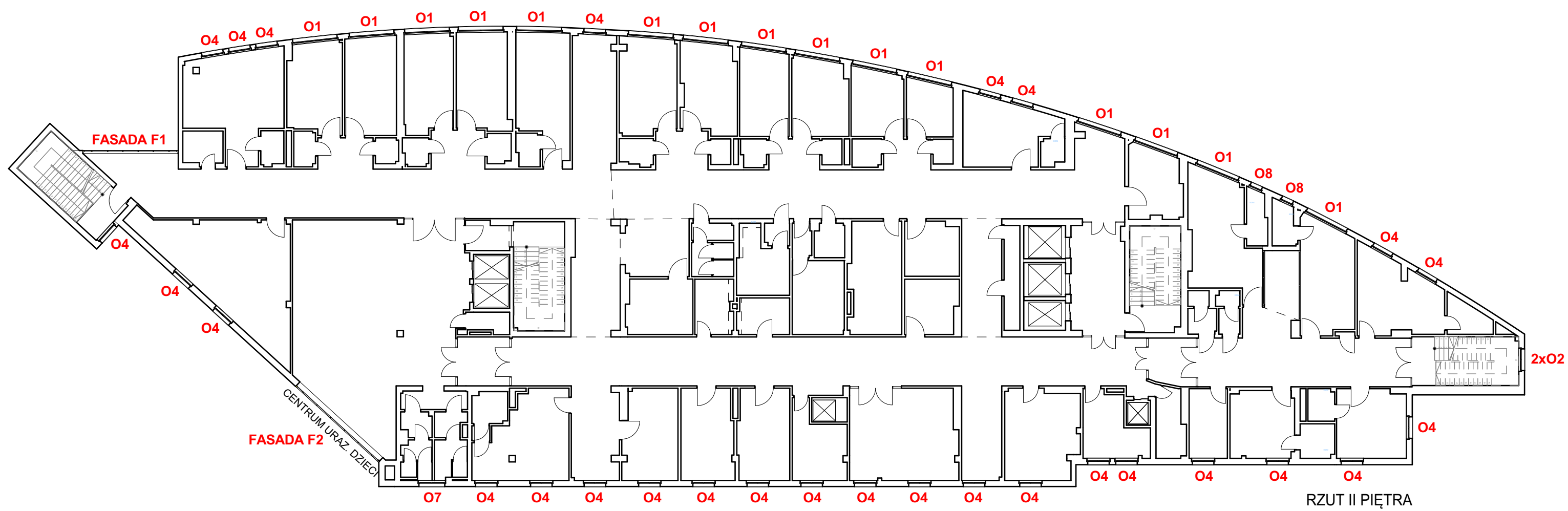
LOKALIZACJA WYMIENIANYCH STARYCH OKIEN NA PROJEKTOWANE OKNA O PROFILACH CIEPŁYCH.
